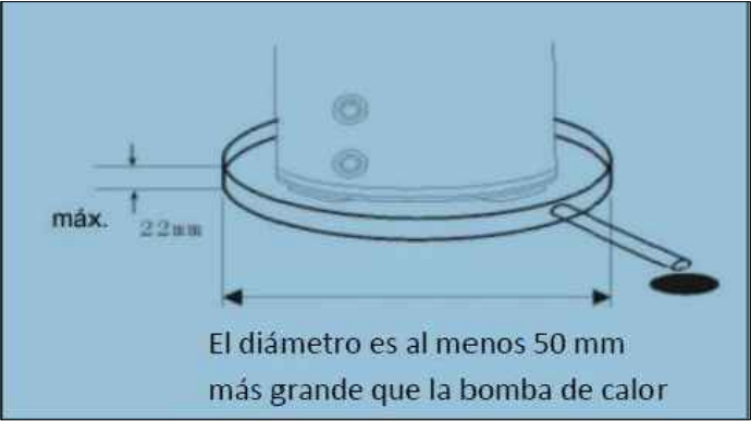
BANDEJA DE ACERO INOXIDABLE A SUMINISTRAR E INSTALAR (TOMA DE DESAGUE Ø HACIA ABAJO)
